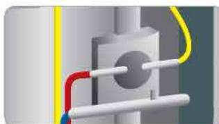
**2. HỆ THỐNG KIỂM SOÁT NHIỆT TRS (Thermal Reed Switch)** giúp kiểm soát nhiệt độ luôn ở mức 70-76°C, làm cho cơm luôn dẻo và đủ ấm trong suốt thời gian giữ ấm.
